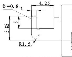
AMP110: 2.8\*0.8                    AMP250: 6.3\*0.8                    PCB焊接端子
